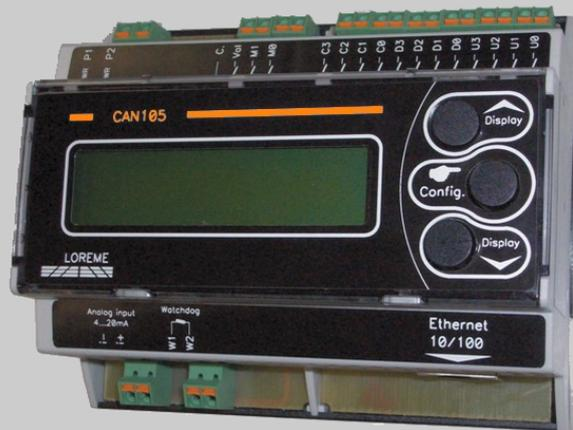
Le CAN105 est un convertisseur analogique numérique permettant la retransmission sous forme binaire, Gray, BCD parallèle d'un signal d'entrée analogique (4...20mA), l'afficheur permet un diagnostic rapide du bon fonctionnement (affichage du courant d'entrée, de l'échelle physique associé et de l'état des sorties).
